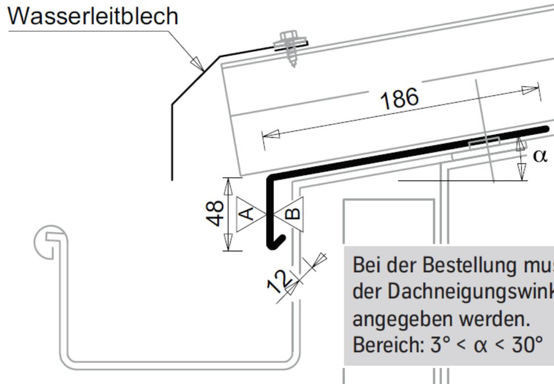
Bei der Bestellung muss der Dachneigungswinkel  $\alpha$  angegeben werden.
